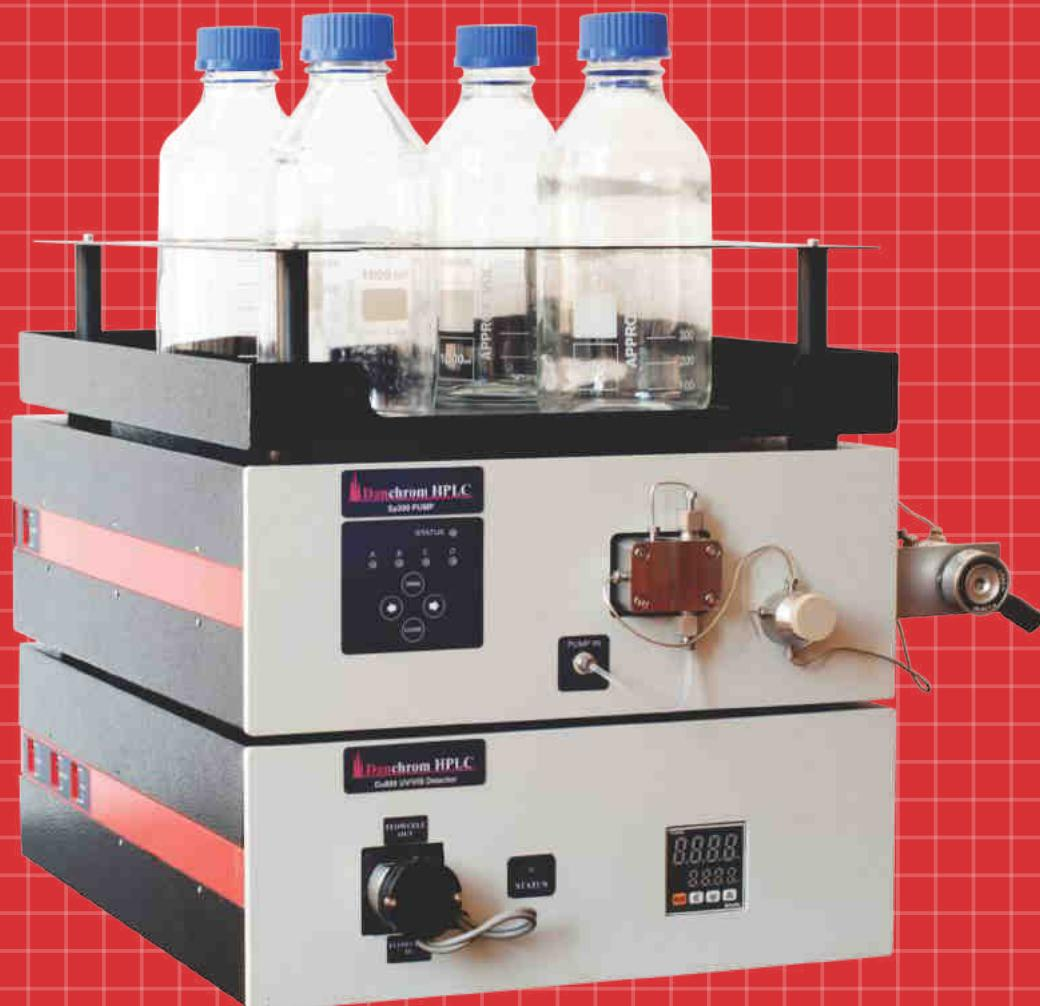
سیستم Analytical HPLC ساخت شرکت کیان شار دانش از یک پمپ قدرتمند و بسیار دقیق با حد جریان (Flow Rate) معادل ۰۰۰۱ تا ۱۰ میلی لیتر بر دقیقه بهره می برد که همراه با آشکارساز UV/Vis مجهرز به فلوسل آنالیتیکال، در عمل کارآئی فوق العاده رضایت بخشی را از خود نشان داده است. این محصول که با نام تجاری DanChrom A1/A2 معرفی می شود، قابلیت بکارگیری در انواع کاربردهای آنالیز به روش های ایزوکراتیک و گرادیان، Method Developement و ... را دارد.
