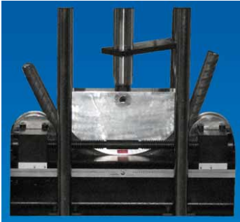
فک خمشی دستگاه خمش ۲۰ تن
