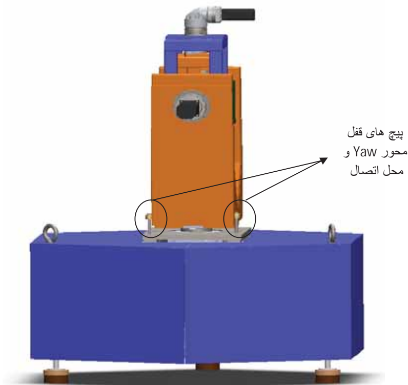
شکل 2- طریقه قفل کردن محور Yaw
