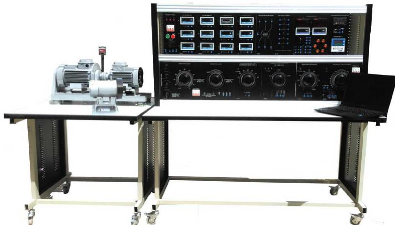
✓ ماشین آستکرون رتور سیم پیچی ۲.۲ kw با قابلیت کار به صورت ماشین سنکرون
