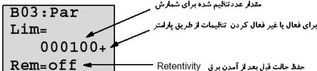
نکته: در ورودی Par در حالت Rem = off وجود دارد که چنانچه در حالت on باشد ، اگر قبل از رفتن برق، خروجی فعال بوده با آمدن برق بدون نیاز به استارت مجدد، خروجی فعال می شود. و چنانچه در حالت off قرار گیرد با قطع ووصل شدن برق، خروجی حالت قبلی خود را حفظ نخواهد کرد.
