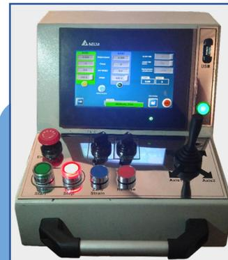
دارای نرم‌افزار رابط کاربری مخصوص در پنل کاربری با کلیدهای کنترلی و HMI برای تنظیم شرایط تست و ذخیره اطلاعات در حافظه جانبی
