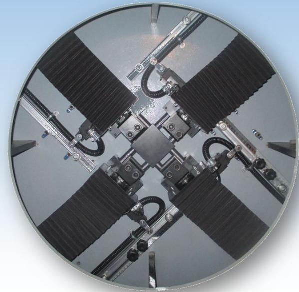
تنش‌های وارد بر ورق‌های فلزی و غیر فلزی حین فرآیندهای ساخت و شکل‌دهی اغلب به صورت دومحوری و از نوع کششی می‌باشند. همچنین تنش‌های اعمالی به انواع پوسته‌ها (Shell) مانند پارچه، چرم و بافت‌های بایو از نوع کششی و چندمحوری است. برای تحلیل و پیش‌بینی دقیق رفتار ورق و پوسته لازم است که کمیت‌های مرتبط با آن به صورت دقیق در آزمایشگاه تعیین شود. کمیت‌های مرتبط با تسلیم، تغییر شکل پلاستیکی و شکست و پارگی از جمله این موارد است. آزمون کشش دومحوری بهترین ابزار برای این منظور است.
