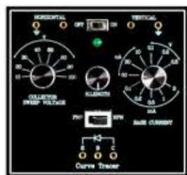
بر روی این سیستم آموزشی یک عدد کروتیسر قرار داده شده است که کاربر به کمک آن می‌تواند منحنی مشخصه خروجی ترانزیستور را بر روی صفحه اسیلوسکوپ مشاهده کند و با محاسبه دقیق نقطه کار ترانزیستور اقدام به طراحی تقویت کننده در
