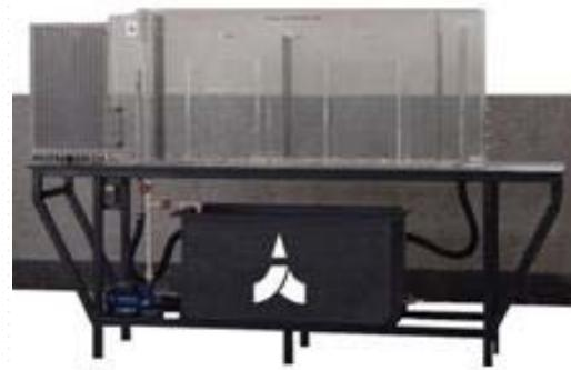
بررسی پدیده نفوذ پذیری محیط های نفوذپذیر مانند سد شنی یا صفحات سوراخ دار و محاسبه ضریب نفوذپذیری و رسم پروفیل فشار در طول تانک نفوذپذیری
