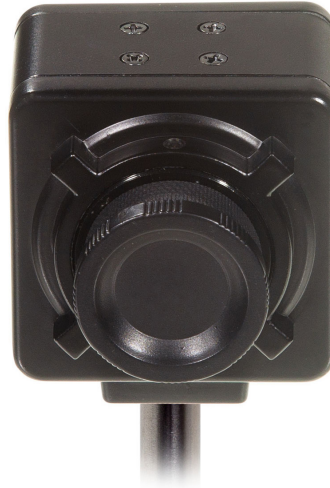
شکل ۲. حسگر نمایه‌سنج دو بعدی - نمای روبرو
