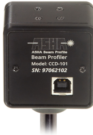
شکل ۳. حسگر نمایه‌سنج دو بعدی - نمای پشت
