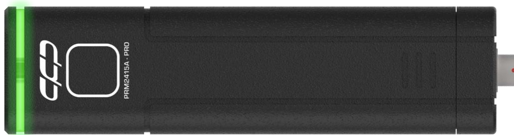
شکل ۳۵ پایین آمدن میزان شمارش از سطح آستانه (رنگ سبز نشانگر بر روی دستگاه).
