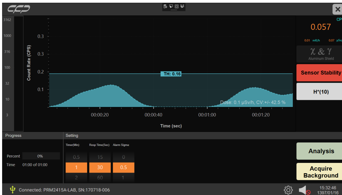
شکل ۳۱ ناپایداری سنسور بر اثر ضربه.
