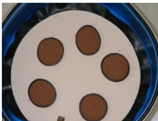
صفحه سرامیکی را درون محفظه فشار (Extractor) منتقل می نماییم.
