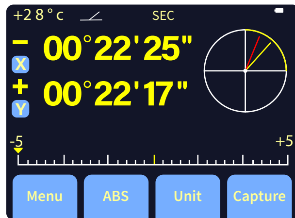
شکل ۱۱. بعد از زدن کلید Unit برای اندازه گرفتن در واحد های
