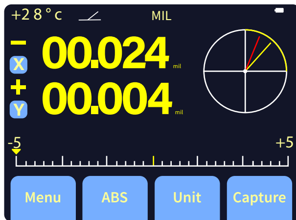
شکل ۱۳. بعد از زدن کلید Unit برای اندازه گرفتن در واحد های مختلف (میل)
