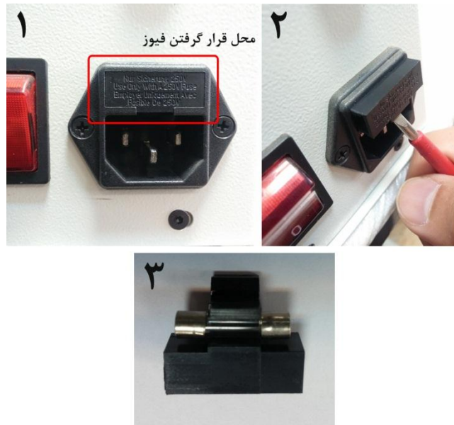
شکل ۱- مراحل تعویض فیوز مولد دستگاه.
