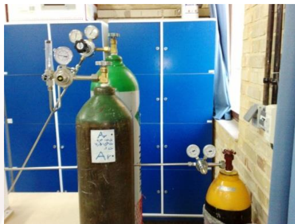
تصویر کیپسول های ازت، آرگون و آمونیاک به همراه رگلاتورهای نصب شده.
