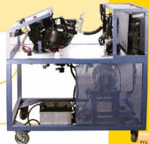
تجهیزات مجموعه: کمپرسور، کندانسور کولر، اوپرатор، رسیور، کلید A/C کولر، ۲ عدد فن
