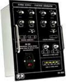
در این سیستم آموزشی دو عدد فانکشن ژنراتور با قابلیت تولید سه نوع شکل موج سینوسی، مثلثی و مربعی با ماکریزم فر کانس 250 کیلوهرتز به عنوان سیگنال های پیام و حامل برای اعمال به بلوک های مختلف در اختیار کاربر قرار داده شده است.
