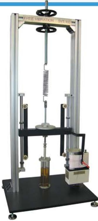
جهت بررسی و تحقیق ارتعاشات سیستم جرم فنر و دمپر دستگاه تست نوسانات یک درجه آزادی با میراکنده طراحی شده است. آزمایش سختی یک فنر استوانه‌ای، فرکانس طبیعی یک سیستم جرم-فنر در حال نوسان، اثر جرم مرتعش بر روی فرکانس یک سیستم جرم-فنر، اثر ضریب میرایی در یک سیستم جرم-فنر را نیز میتوان انجام داد همچنین از روی گراف مقدار  $K$  (سختی فنر) و  $C$  (ضریب دمپینگ) دوره‌تناوب تجربی بدست آمده با مقدار تئوری مقایسه می‌شود.
