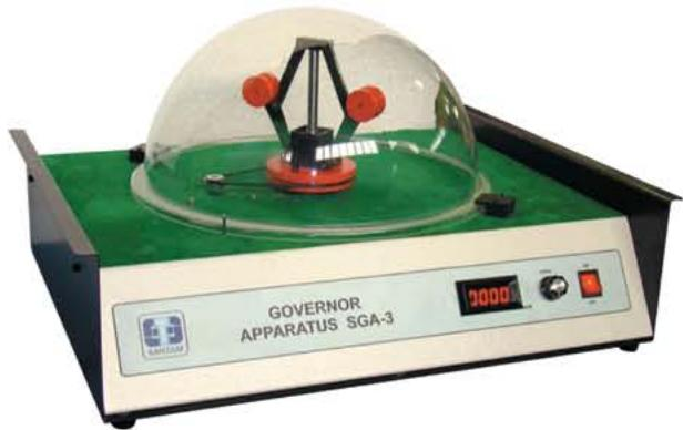
جهت بررسی منحنی مشخصه گاورنر، اختلاف و مقایسه بین منحنیهای واقعی و تئوری گاورنرها، ارتباط وزنه Sleeve با دیگر مشخصه های گاورنر، ارتباط بین نسبت بازوی گاورنر و ضریب سختی فنر و میزان فشرده‌گی و بررسی پایداری و حساسیت گاورنر دستگاه گاورنر طراحی شده است.
