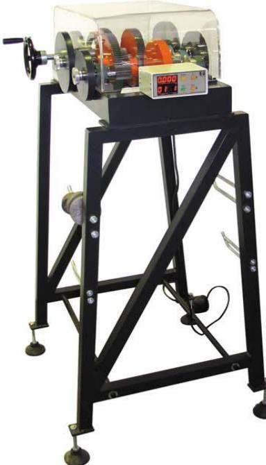
جهت بررسی و تحقیق در خصوص راندمان چرخدنده‌های ساده و بررسی دینامیک دورانی چرخدنده‌های ساده طراحی شده ممان اینرسی هریک از شفتهای و زنجیره چرخدنده‌ها با داشتن کشتاور اعمالی و شتاب زاویه‌ای سیستم قابل محاسبه خواهد بود سرعت دوران با استفاده اپتوکوپلر نوری و نمایش لحظه‌ای سرعت دوران به صورت دیجیتال اندازه‌گیری می‌شود آزمایش تعیین شتاب زاویه‌ای چرخدنده‌ها، تعیین مماس اینرسی کلی چرخدنده‌ها، اندازه‌گیری اصطکاک، محاسبه بازده چرخدنده‌ها را می‌توان انجام داد
