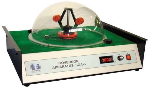
جهت بررسی منحنی مشخصه گاورنر، اختلاف و مقایسه بین منحنیهای واقعی و تئوری گاورنرها، ارتباط وزنه Sleeve با دیگر مشخصه های گاورنر، ارتباط بین نسبت بازوی گاورنر و ضربی سختی فنر و میزان فشردگی و بررسی پایداری و حساسیت گاورنر دستگاه گاورنر طراحی شده آزمایش سینماتیک سیستم های گاورنر گریز از مرکز گاورنر Porter ، گاورنر پروئل Proell ، گاورنر هارتلن Hartnell را می توان انجام داد دستگاه مجهز به درایور با قابلیت کنترل دور و نمایش لحظه ای سرعت دوران به صورت دیجیتال و مجهز به موتور و حفاظ بوده
