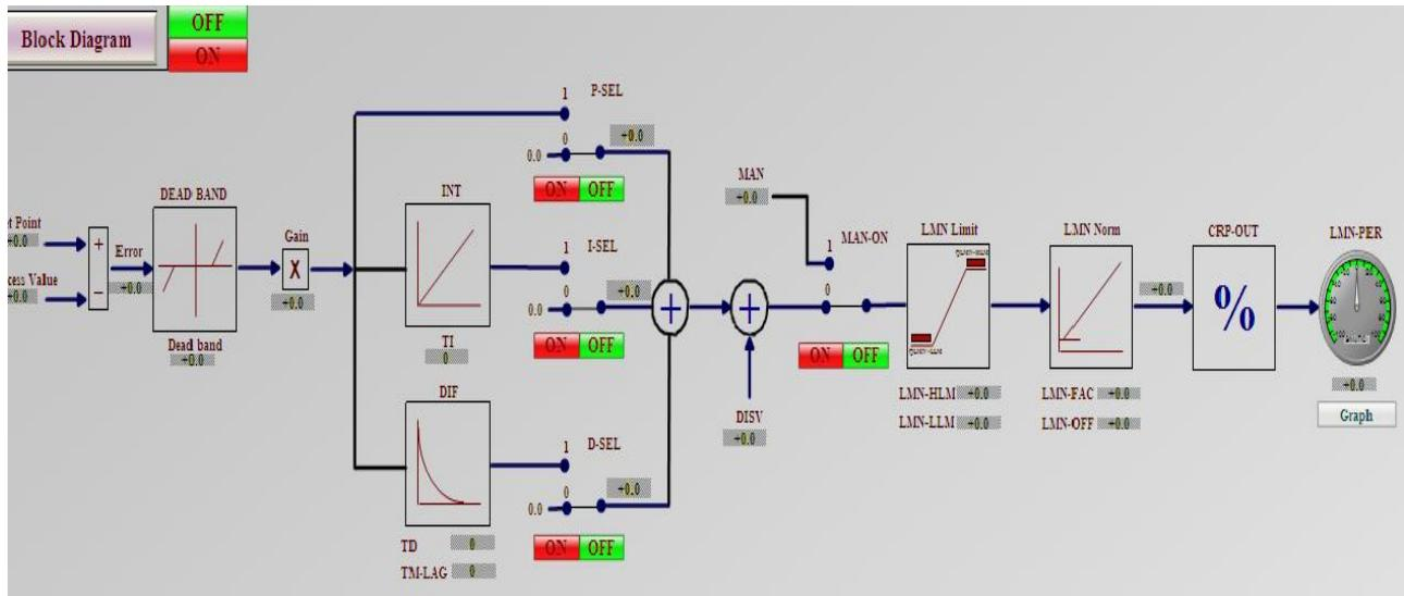
در صفحه پردازش فرآیند، نمودارهای فرآیند نمایش داده شده و تأثیر تغییر پارامترها به صورت نمودار نمایش داده می شود. با تغییر پارامترهای PID می توان تغییرات نمودارها را مشاهده و آنالیز نمود.
