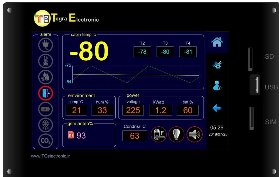
دستگاه مدل LFR-M70A یک سیستم جامع و یکپارچه جهت کنترل و مانیتورینگ انواع سیستم های برودتی مانند یخچال و فریزر های آزمایشگی، فریزرهای منفی 40 ، فریزر های منفی 80 و بانک خون می باشد. این دستگاه با دارا بودن انواع سنسورها و کنترلر های مورد نیاز ، نمایشگر ، دینالاگر ، المان های مورد نیاز شبکه، نرم افزار کامپیوتر و تلفت همراه ، محافظ برق ، شارژر و سیستم مدیریت باتری ، سیستم های کنترل از راه دور و ... ، نیاز الکترونیکی و الکتریکی این سیستم ها را به طور کامل مرتفع می نماید.
