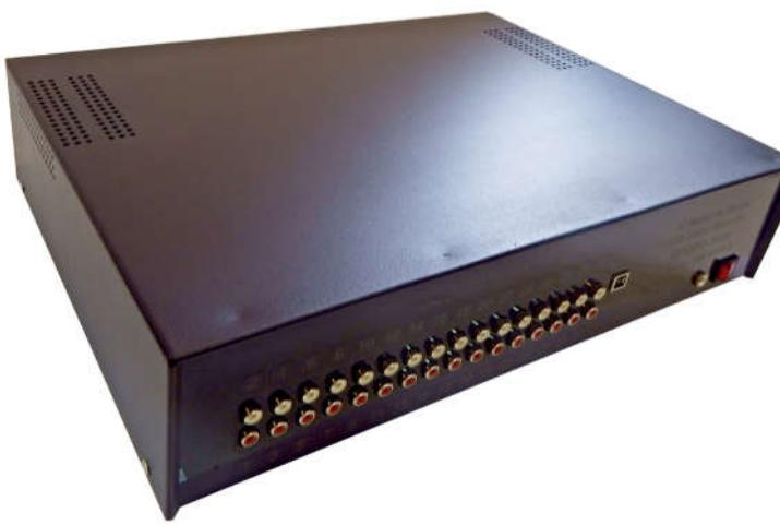
ضبط کننده صدا ۳۲ کاناله قابلیت ضبط همزمان ۳۲ کanal صدا به صورت Mono و یا ۱۶ کanal به صورت Stereo را دارد. قابلیت نمونه برداری با نرخ ۴۸ کیلوهرتز با روزلیشن ۲۴ بیت قابلیت مهم این سیستم می باشد.
