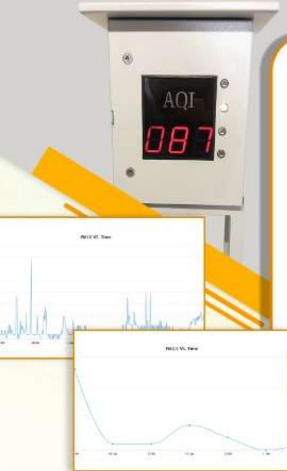
دستگاه پایش ایستگاهی آلاینده‌های هوای محیط (SAPA) جهت اندازه‌گیری آلاینده‌های هوای شهری از جمله ذرات معلق با قطر کمتر از ۱۰ میکرومتر (PM<sub>10</sub>) و کمتر از ۲.۵ میکرومتر (PM<sub>2.5</sub>) و همچنین گازهای آلاینده‌ی ازن (O<sub>3</sub>), کربن مونوکسید (CO), نیتروژن دی‌اکسید (NO<sub>2</sub>) و گوگرد دی‌اکسید (SO<sub>2</sub>) به کار می‌رود.
