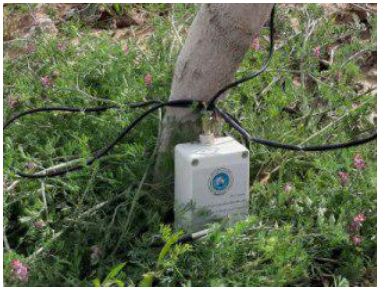
دستگاه دمانگار مینیاتور هوشمند فوق کم مصرف نصب شده در باغ پسته
