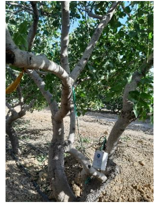
دستگاه دمانگار مینیاتور هوشمند فوق کم مصرف نصب شده در باغ پسته
