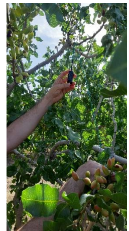
سنسور سنجش دما و رطوبت هوا در دستگاه دمانگار مینیاتور هوشمند فوق کم مصرف نصب شده در باغ پسته
