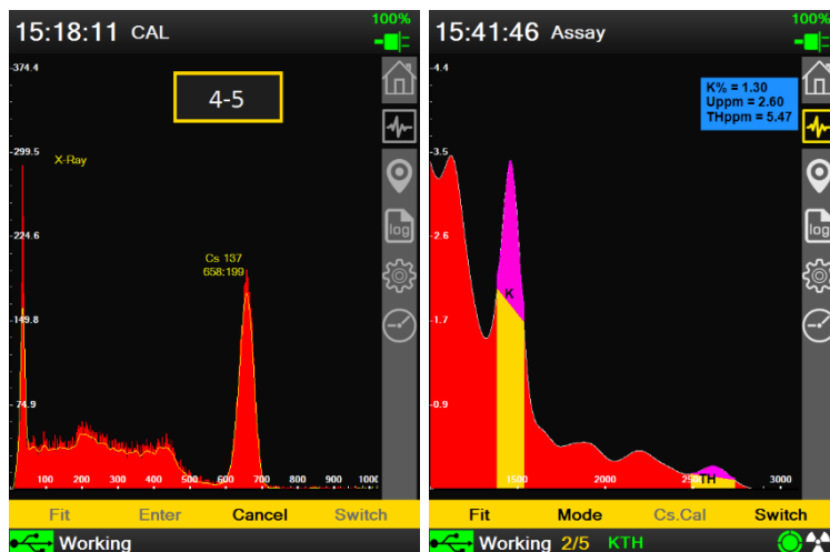
شکل ۹ صفحه نمایش دستگاه در قسمت گراف ها (الف) در حالت کار، (ب) در حالت کالیبراسیون
