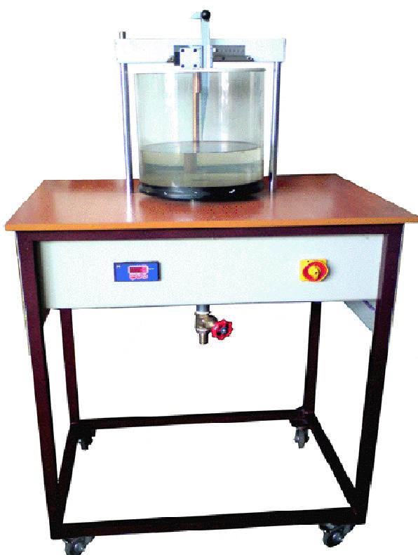
دستگاه ورتکس به دانشجویان امکان می‌دهد ورتکس‌های آزاد و اجباری را تولید و پروفیل سطح آب ورتکس را اندازه‌گیری کنند. دستگاه شامل یک محفظه شفاف است که روی یک چارچوب نگهدارنده نصب شده است و روی میز هیدرولیک قرار می‌گیرد. یک موتور DC کوچک با دور متغیر محفظه را حول محور عمودی می‌چرخاند. سرعت چرخش توسط یک کنترل کننده سرعت الکترونیکی کنترل می‌شود.
