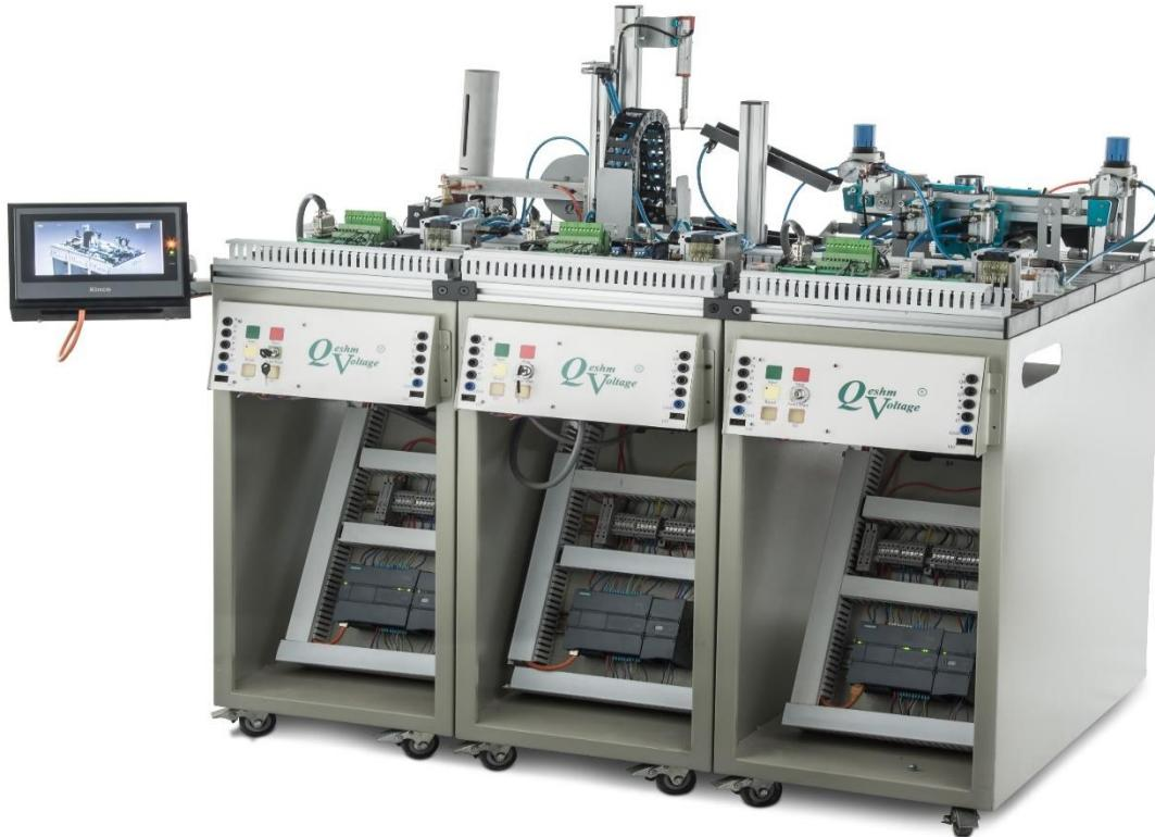
مجموعه فوق ترکیبی از بخش مکانیک و الکترونیک می باشد که هر دو بخش مستلزم مراقبت و نگهداری می باشد . در بخش مکانیک می بایست کلیه تجهیزات ( نظیر سیلندرها ، بروفیل ها ، ساپورتها و .... ) هر ماه از لحاظ عملکرد ، خوردگی ، زنگ زدگی و .... بررسی شوند. شلنگهای پنوماتیک ، فلو کنترلرها می بایست از لحاظ نشتی هوا بررسی شوند. در بخش الکترونیک نیز می بایست سنسورها ، موتورها، شیربرقی ها از لحاظ اتصال به فانکشن سیمولاטור ( قطعی سیم و خرابی فیشهای ) بررسی شوند.
