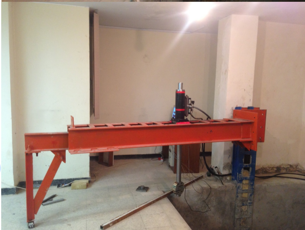
اکچواتور ۱۰ تن استفاده شده جهت مدل فیزیکی بزرگ مقیاس (ابعاد چاله: ۲ متر در ۲ متر)
