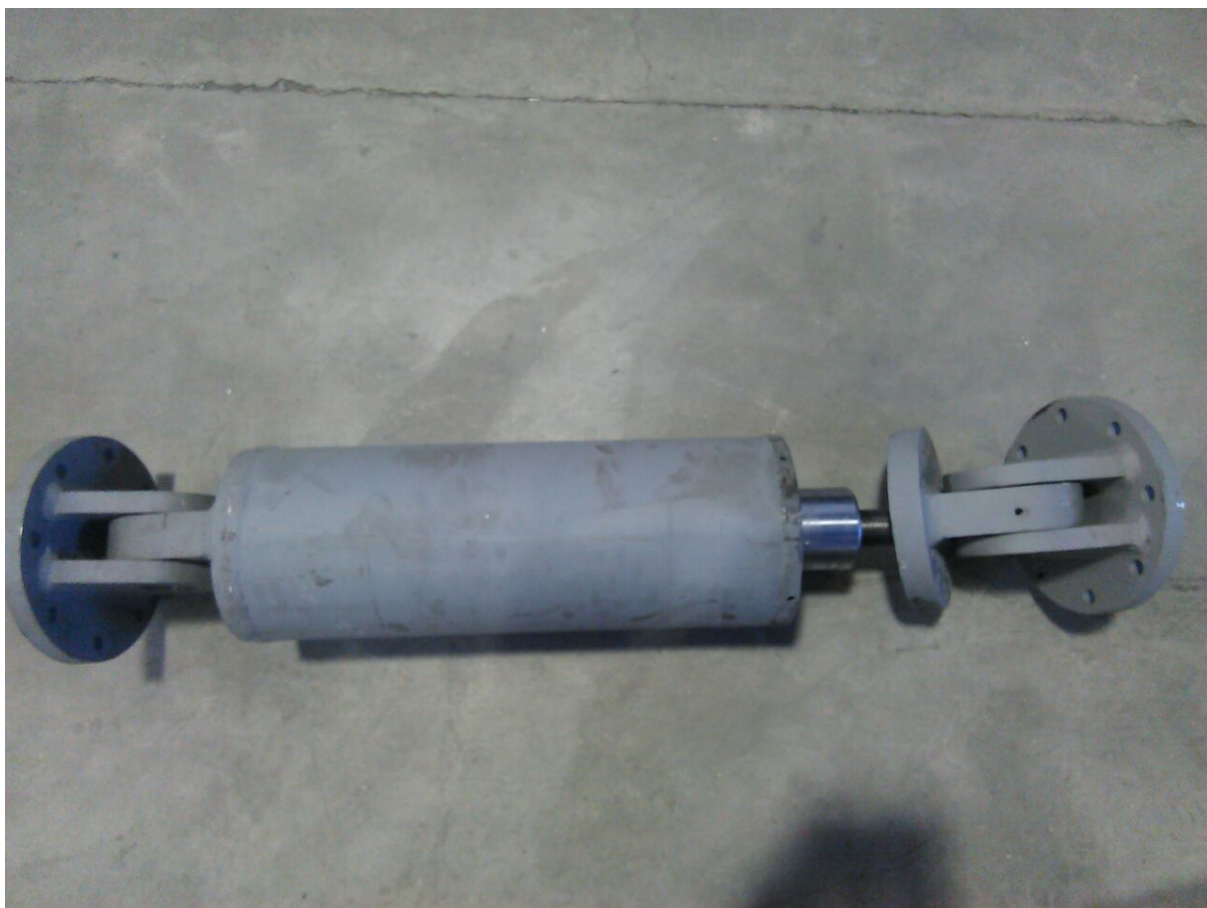
اکچواتور ۵۰ تن استفاده شده جهت آزمایشگاه سازه
