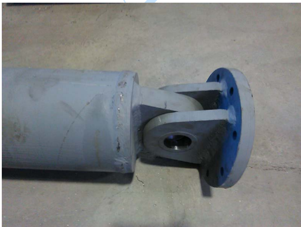
اتصال گوی و کاسه ای بدون لقی استفاده شده در اکچواتورهای مخصوص بارگذاری سازه ها
