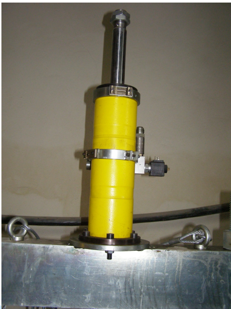
اکچواتور ۱۰ تن مستقر برو روی قاب دستگاه سه محوری دینامیکی به قطر ۳۰ سانتیمتر
