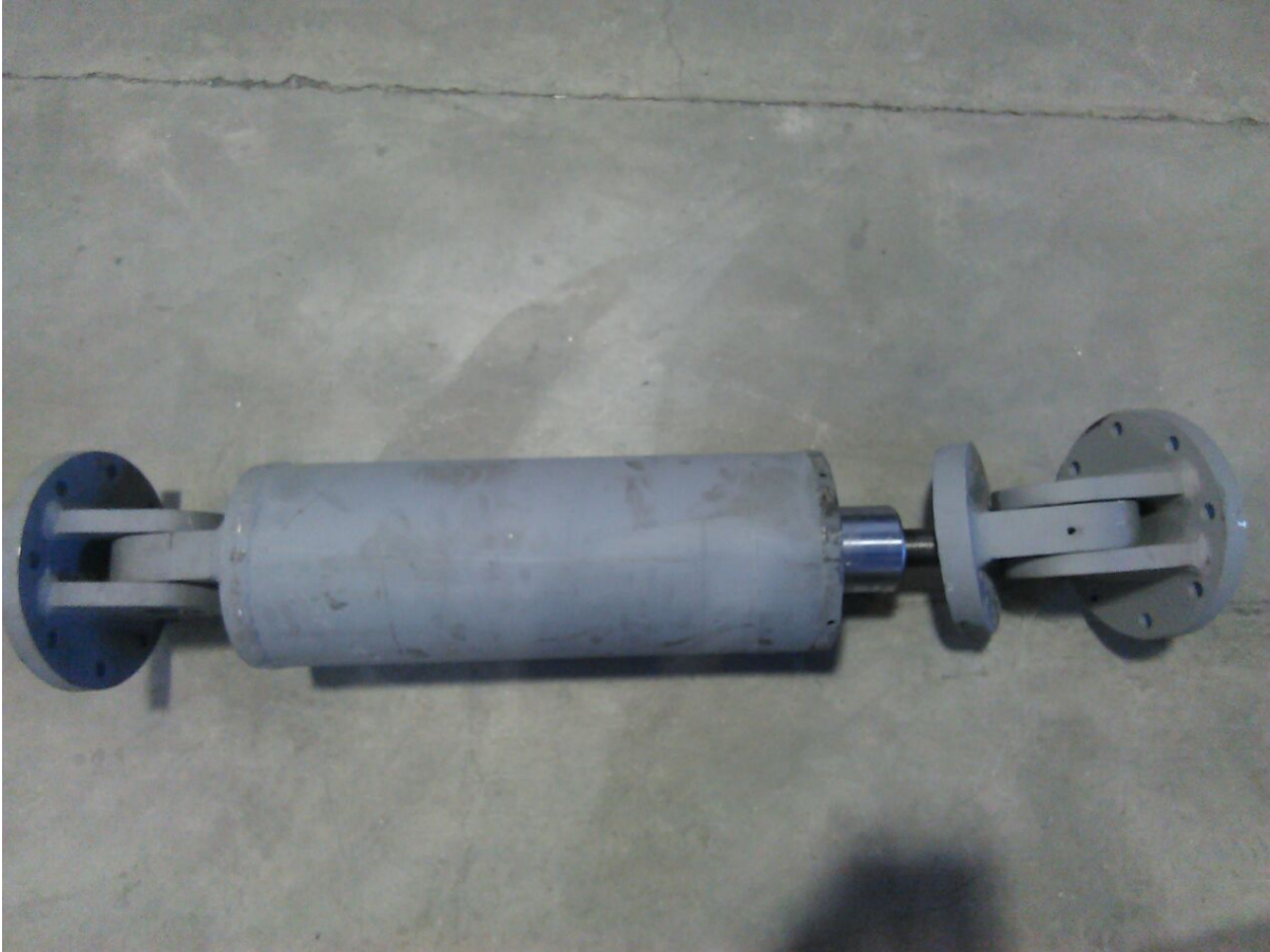
اکچواتور ۵۰ تن استفاده شده جهت آزمایشگاه سازه
