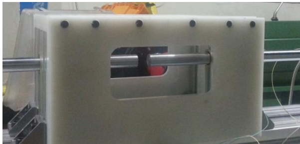
نمایی از اتاقک محافظ در دستگاه هایپکینسون بار فشاری
