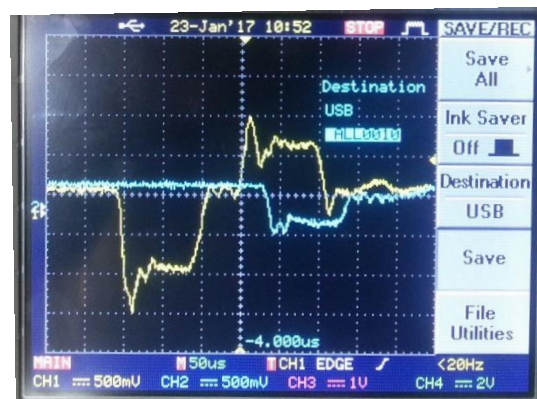
نمایی از موج های Transmitted, Reflected, Incident
