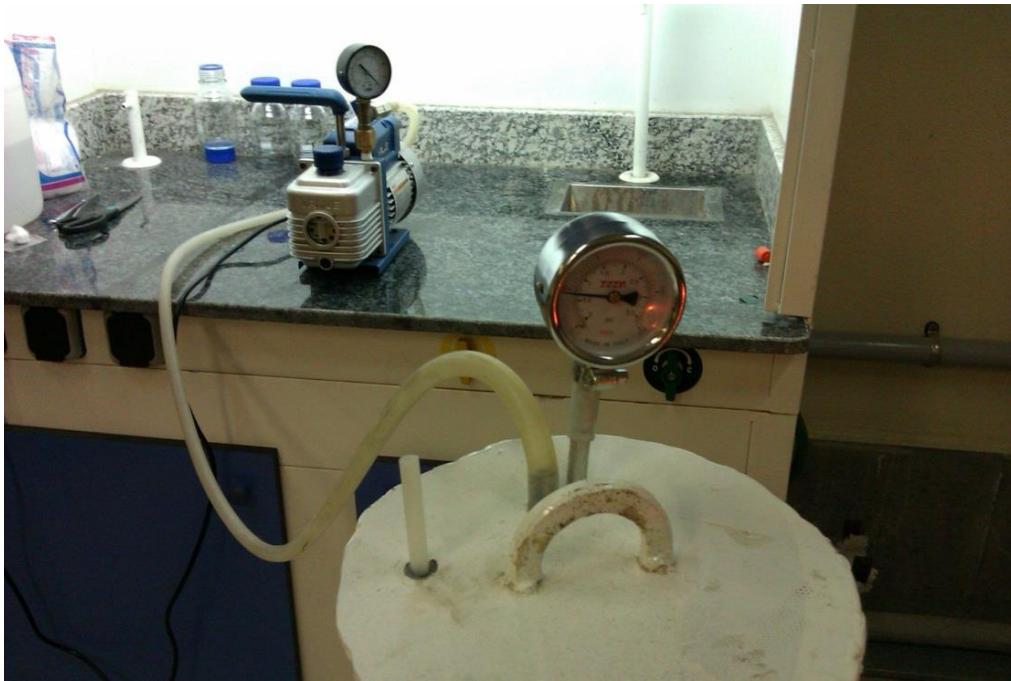
شکل ۳- نمایی از سیستم خنک کننده و پمپ خلا.
