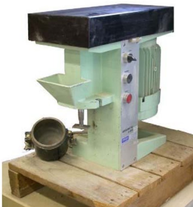
شکل ۱- دستگاه آزمایش سایش LCPC. این دستگاه تیغه آزمایش را در مدت ۵ دقیقه با سرعت ۴۵۰۰ دور بر دقیقه در
