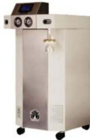
این دستگاه کامل ترین دستگاه تولیدی بوده و علاوه بر داشتن خروجی آب TYPE III و خروجی TYPE I دارای خروجی TYPE I DEGAS نیز بوده و در صورت نیاز، گاز موجود در آب فوق خالص آن می تواند جدا شود. با انتخاب گزینه های مناسب در صفحه LCD می توان بخش گاز زدا را فعال نموده و آب گاز زدایی شده را از دستگاه دریافت نمود. این دستگاه پرتابل و قابل حمل میباشد و میتوان آن را به جاهای مختلف برد. حجم و میزان تولید این دستگاه با دستگاههای دیگر متفاوت می باشد.
