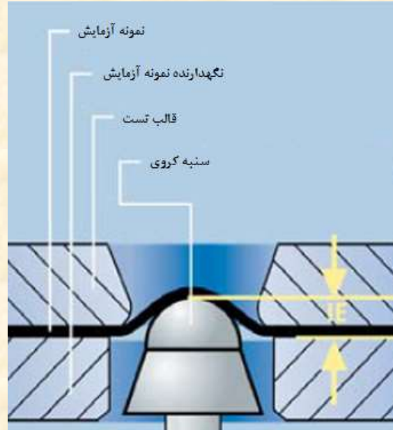
شکل ۸. مکانیزم تست جامی شدن
