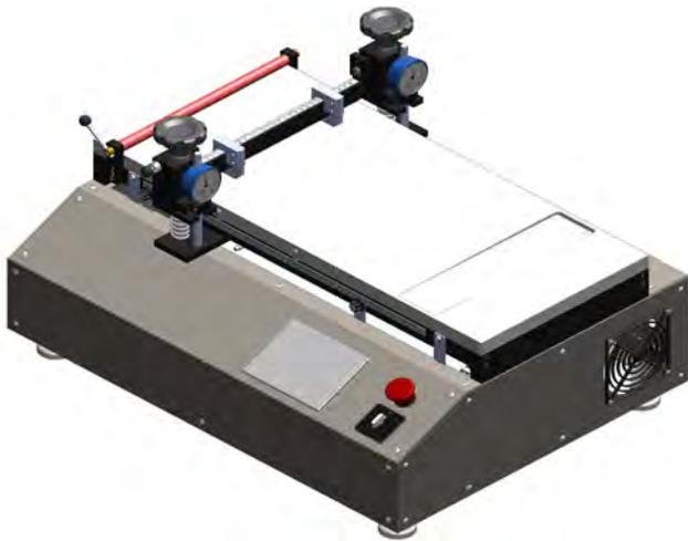
بکمک این دستگاه می توان به پوشش دهی دقیق و قابل تکرار مواد ویسکوز همانند رنگ، رزین، چسب، پلیمر و سایر مواد مشابه با ضخامتهای دلخواه بر سطح بستره مورد نظر مطابق با استاندارد ASTM D ۸۲۳- Practice C اقدام نمود.
