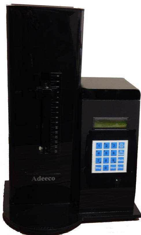
این دستگاه برای لایه‌نشانی نانو ذرات (nano particle) به صورت لایه به لایه (layer by layer) بسیار مناسب می‌باشد.
