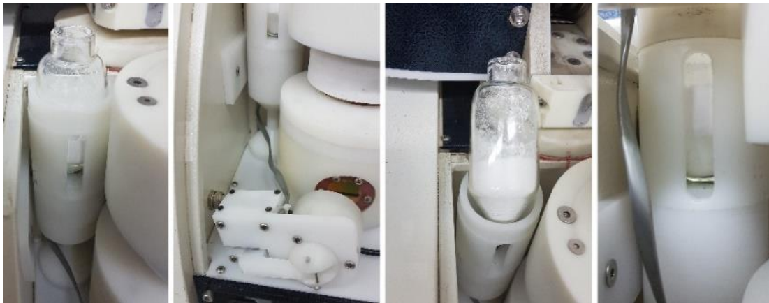
تصویر 23 اجزای محفظه دارو و نحوه قرار گیری آنها
