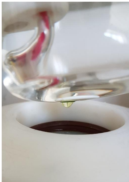
تصویر 27 مایع انکوباتور چسبیده به دیواره خارجی بشر حین جداسازی
