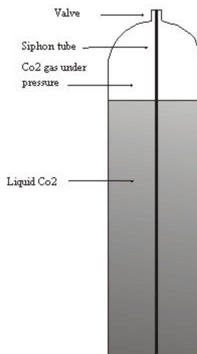
کپسول  $\text{CO}_2$  مایع دارای میل آب (Dip Tube)
