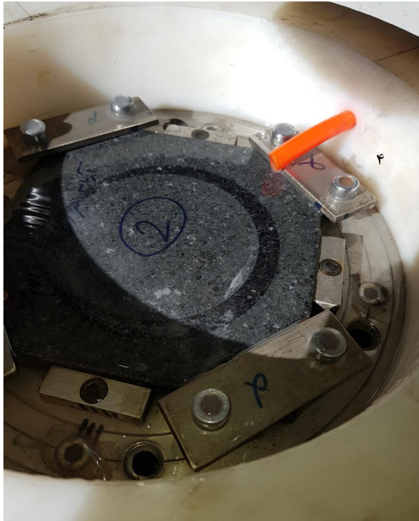
فیکسچر سنگ و نحوه نگهدارند آن
