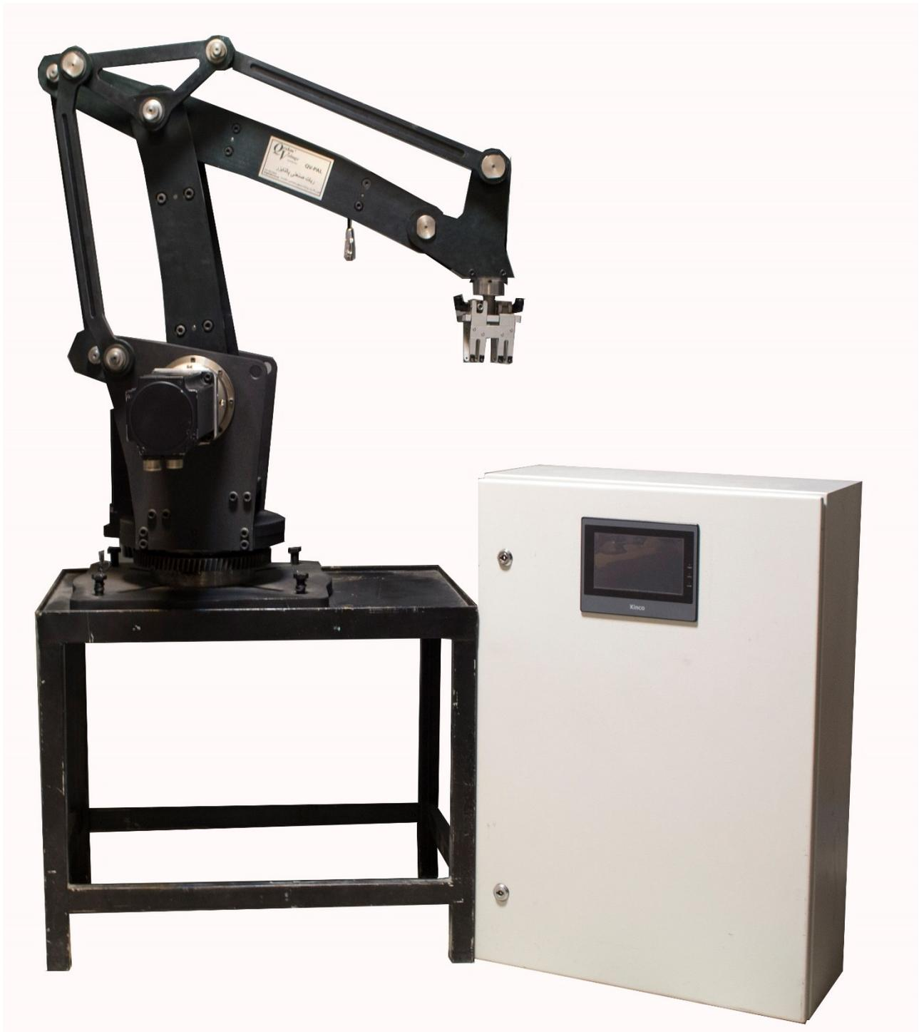
مجموعه فوق ترکیبی از بخش مکانیک و الکترونیک می باشد که هر دو بخش مستلزم مراقبت و نگهداری می باشد. در بخش مکانیک می بایست کلیه تجهیزات ( نظیر سیلندر، بدنه، گریپر و .... ) هر ماه از لحاظ عملکرد، خوردگی، زنگ زدگی و .... بررسی شوند. شلنگ پنوماتیک می بایست از لحاظ نشتی هوا بررسی شود. در بخش الکترونیک نیز می بایست سنسورها، موتورها و تابلو کنترل از لحاظ عدم قطعی سیم و سلامتی بررسی شوند.
