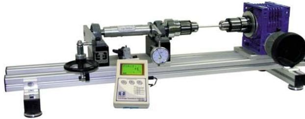
دستگاه آزمایش پیچش STS-50 جهت تعیین مقاومت برشی مواد مختلف تا ظرفیت 50N.m بروی نمونه آزمایش های استاندارد، کاربرد دارد. گشتاور اعمالی بوسیله یک گشتاور سنج دیجیتال و مقدار زاویه پیچش از طریق نقاطه های متصل به گیربکس کاهنده (دردو جهت) قابل اندازه گیری می باشدند.
