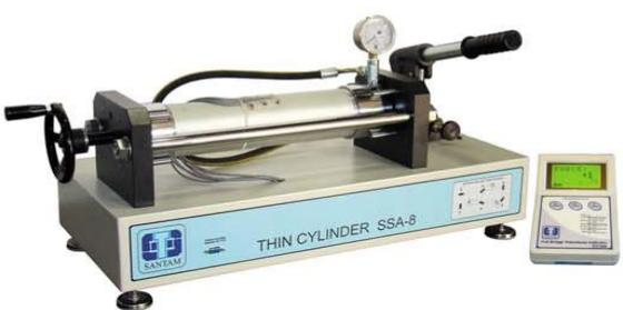
این دستگاه جهت تحقیق و بررسی تنش و کرنش سطحی سیلندر های تحت فشار در زوایای مختلف به کار می رود. نصب ۶ عدد استرین گیج بروی سطح سیلندر جهت بررسی تنش های مماسی و طولی سیلندر، با قابلیت آزمایش به دو شکل شرایط انحنای بسته و باز به همراه کرنش سنج دیجیتال جهت قرائت هر یک از کرنش ها
