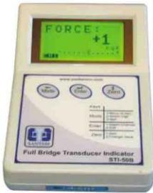
جهت نمایش نیرو، گشتاور، فشار، کرنش سنج، تغییر طول، و ... که ساختار پل مقاومتی دارند می‌توان از دستگاه نشان دهنده ترانسdiوسر دیجیتال STI-50 استفاده نمود. این دستگاه سیکل‌های الکترونیکی حس شده توسط ترانسdiوسرهای تمام پل (Full Bridge) مقاومتی را تقویت کرده و به صورت دیجیتال با واحد نام مورد نظر، نمایش می‌دهند
