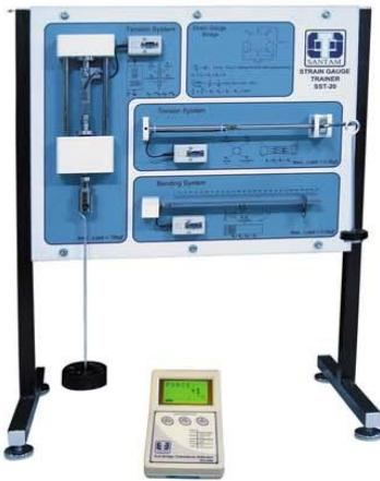
برای آشنائی با طرز کار استرین گیج ها (Strain-Gauge) بر اساس قانون پل و تستون می توان از دستگاه تنش و کرنش مدل SST-20 استفاده نمود.
