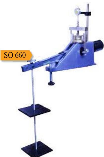
SO 660-1\*: ساعت اندازه‌گیری بنا بر سفارش به ساعت اندازه‌گیری دیجیتال با دقت 0.01mm قابل تغییر می‌باشد.
