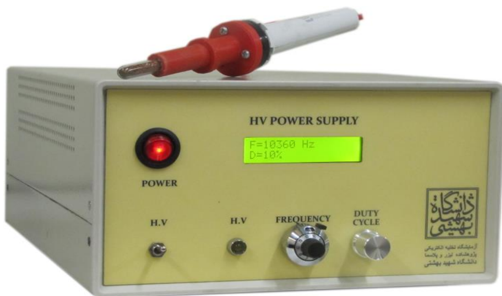
آزمایش ۷: دستگاه تولید پلاسمای سرد
