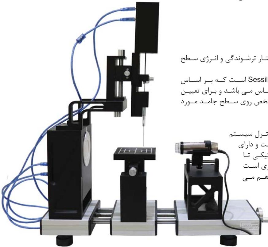
سیستم اندازه گیری زاویه تماس ابزاری جهت مطالعه رفتار ترشوندگی و انرژی سطح توسط یک مایع می باشد.
