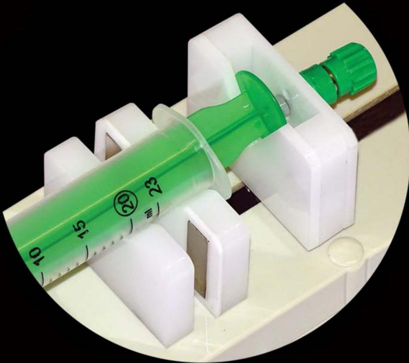
۵- مطابق شکل با از طریق چرخاندن پیچ نگه دارنده پیستون، پیستون سرنگ را در جای خود محکم کنید.
