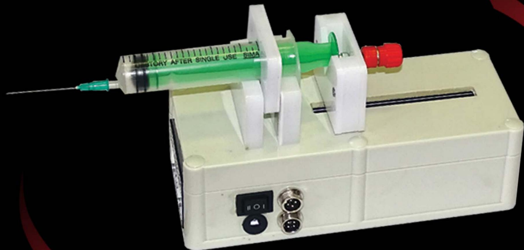
دستگاه پمپ سرنگی، یکی از وسایل پرکاربرد در آزمایشگاه های مهندسی شیمی، مهندسی مواد و آزمایشگاه های تحقیقاتی و کاربردی علوم پایه می باشد. تزریق مایعات با گر انروی های مختلف در حجم های کنترل شده و در زمان های قابل برنامه ریزی، از قابلیت های این دستگاه است. پمپ سرنگی برهان در دو نوع فشار پایین و فشار بالا تولید میگردد و دارای دو بخش کنترلر و ماژول پمپ است. ماژول پمپ با استفاده از یک سیم به کنترلر متصل میگردد.
