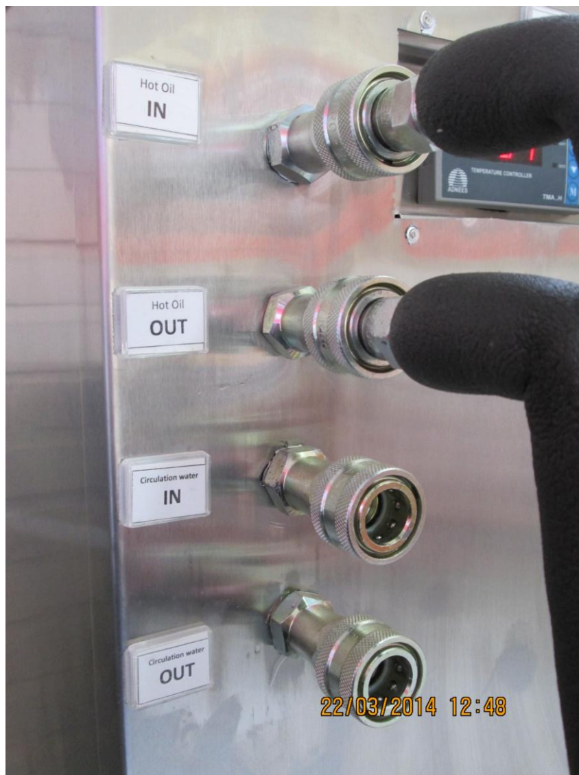
شکل ۲- ورودی و خروجی آب مبرد و روغن انتقال حرارت
