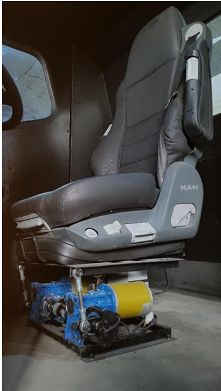
شکل ۱۴- پیاده‌سازی سیستم حرکتی دو درجه آزادی برای صندلی اپراتور به صورت بومی (ساخت ایران - شرکت فناوری شبیه‌ساز نصیر)
