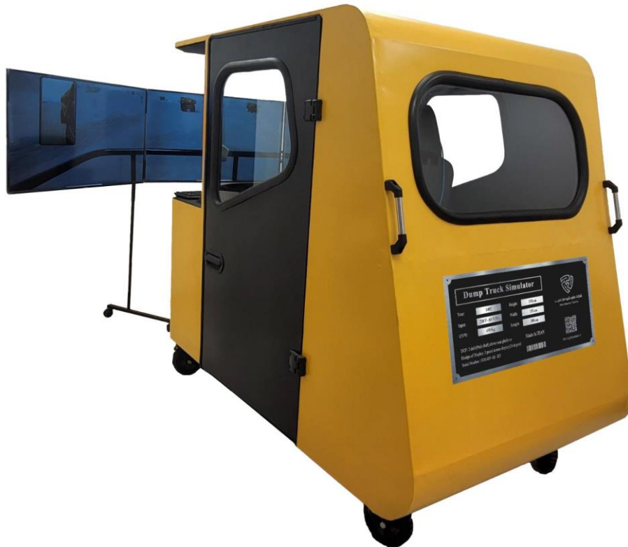
شکل ۶- نمونه دستگاه شبیه‌ساز دامپ‌تراک با بدنه‌ی تولیدی داخل (ساخت ایران - شرکت فناوری شبیه‌ساز نصیر)
