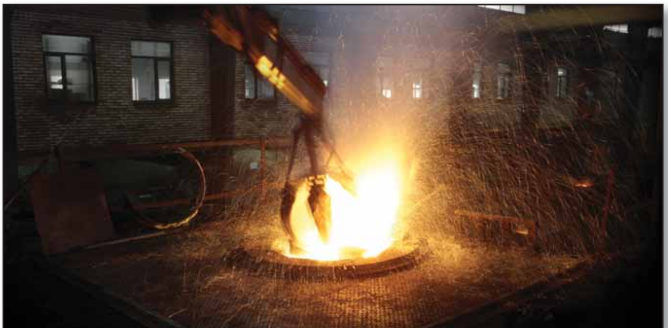
سیستم شارژ کوره القایی ۵ تن
