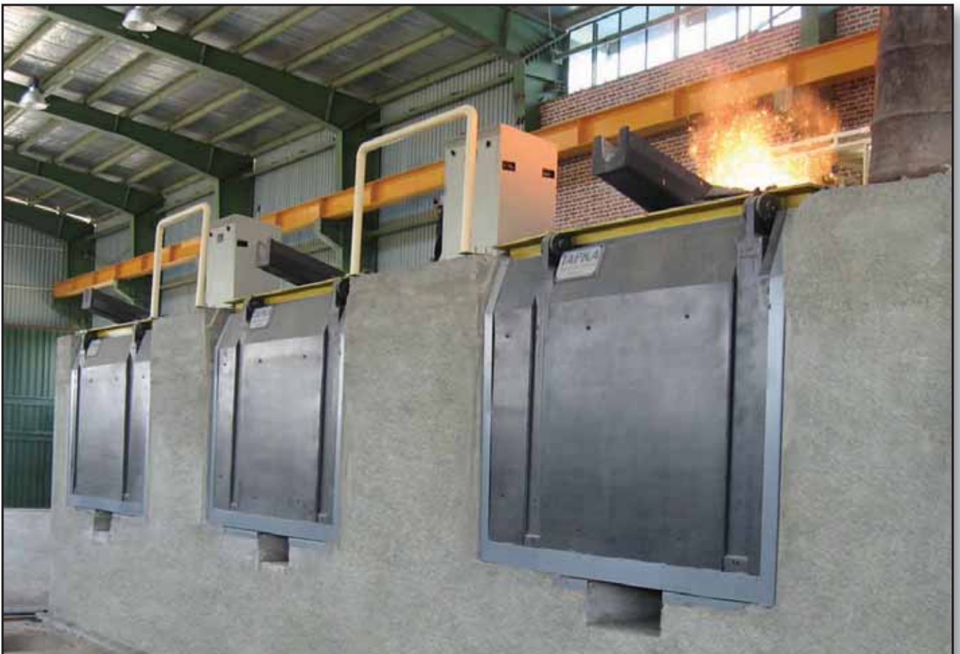
دو دستگاه کوره القایی ۲ تن با آرایش W
