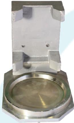
در آزمایش مقاومت فشاری نمونه های بتن استوانه ای شکل، به دلیل نیاز به یکنواخت اعمال شدن نیروی وارد بر دو سطح تماس و جلوگیری از شکست زود هنگام نمونه، دو انتهای نمونه به وسیله ملاتی زودگیر کلاهک گذاری می شود. ملات کلاهک گذاری (Capping) از ترکیب گوگرد و ماده ی پرکننده (سیلیس) تشکیل می شود. با مخلوط کردن گوگرد و سیلیس به نسبتی مشخص طبق استاندارد در ظرف مناسب و حرارت دادن مخلوط تا نقطه ذوب مخلوطی بدست می آید که برای کلاهک گذاری نمونه بتن استوانه ای استفاده می شود.
