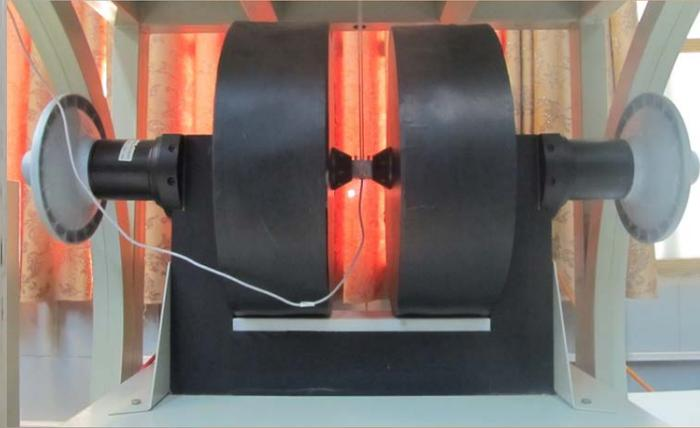
این الکترومگنت جهت استفاده در مراکز پژوهشی و صنعتی که نیاز به میدان مغناطیسی پایدار و یکنواخت دارند در دو مدل فوق طراحی و ساخته شده است.
