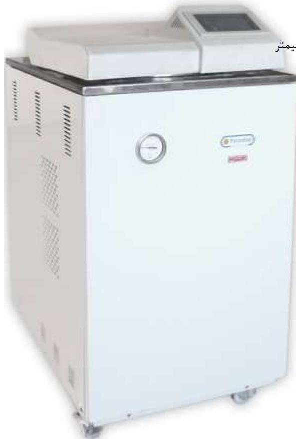
بدنه خارجی : از جنس ورق گالوانیزه با پوشش رنگ الکترو استاتیک به ضخامت ۲ میلیمتر
